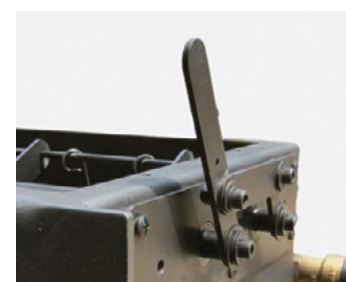
Sistema de limpieza semi automático con turbuladores.
